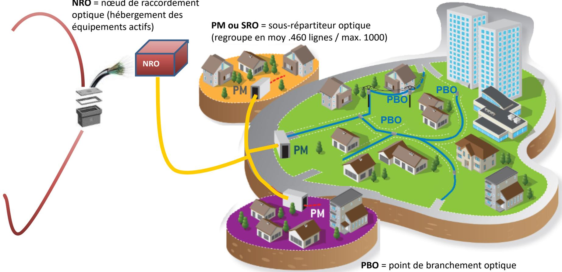
**PBO** = point de branchement optique (souterrain, aérien ou façade)
