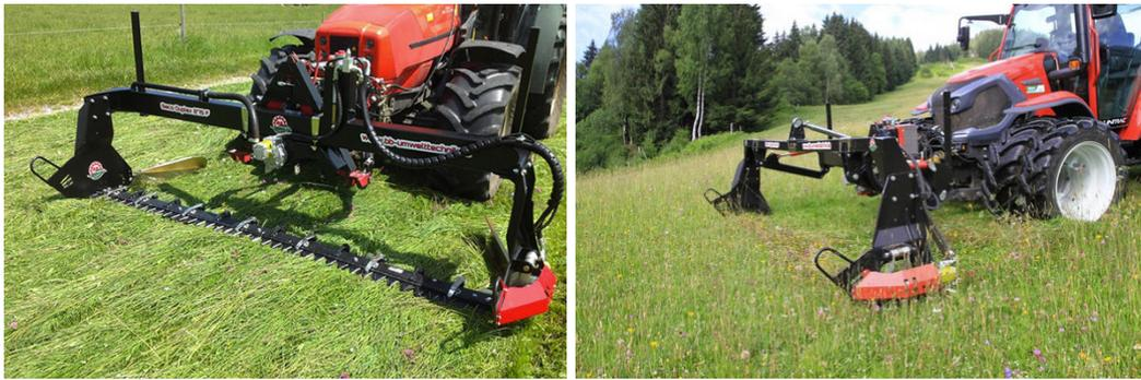
Figure 89 : Exemple de matériels utilisant une barre de coupe à double-lame. © BB Umwelttechnik ( source : <https://doppelmessermähtwerk.de/> )
